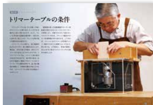
トリマーテーブルによる加工
